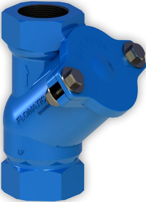
Modelo 508 - Cuerpo de hierro dúctil con recubrimiento de epóxico de unión fusión. "Bola de hundimiento" fenólica resistente a la corrosión estándar, con asiento resiliente, con cubierta de acceso con dos pernos.
